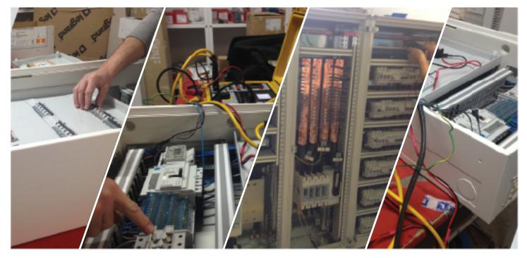
A RTL dispõe de um departamento técnico, no qual os quadros de distribuição são electrificados e montados mediante o projecto do cliente.
